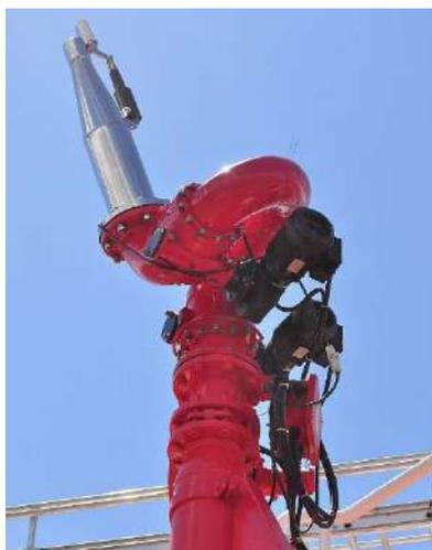
Рис. 3. Дистанционно-управляемый лафетный ствол на пожарном судне.
