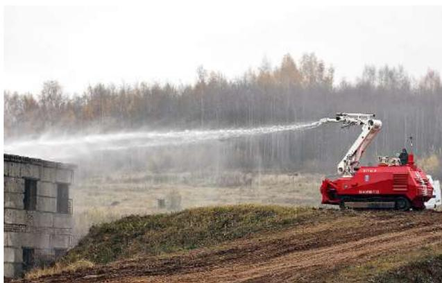
Рис. 1. Пожарный робот «Ель-4».
