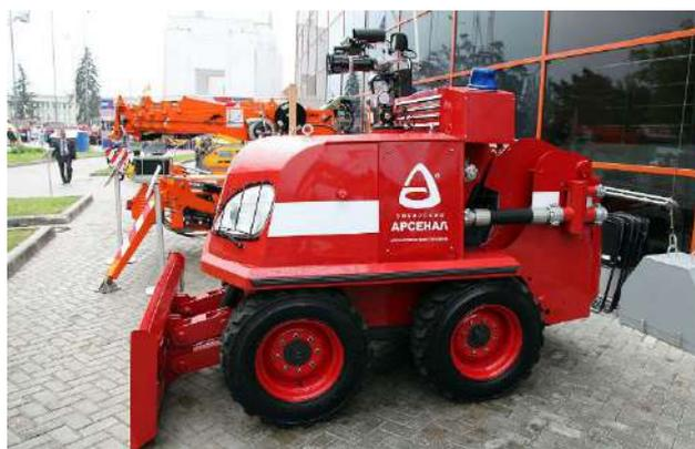
Рис. 2. Пожарный робот «Пеликан».
