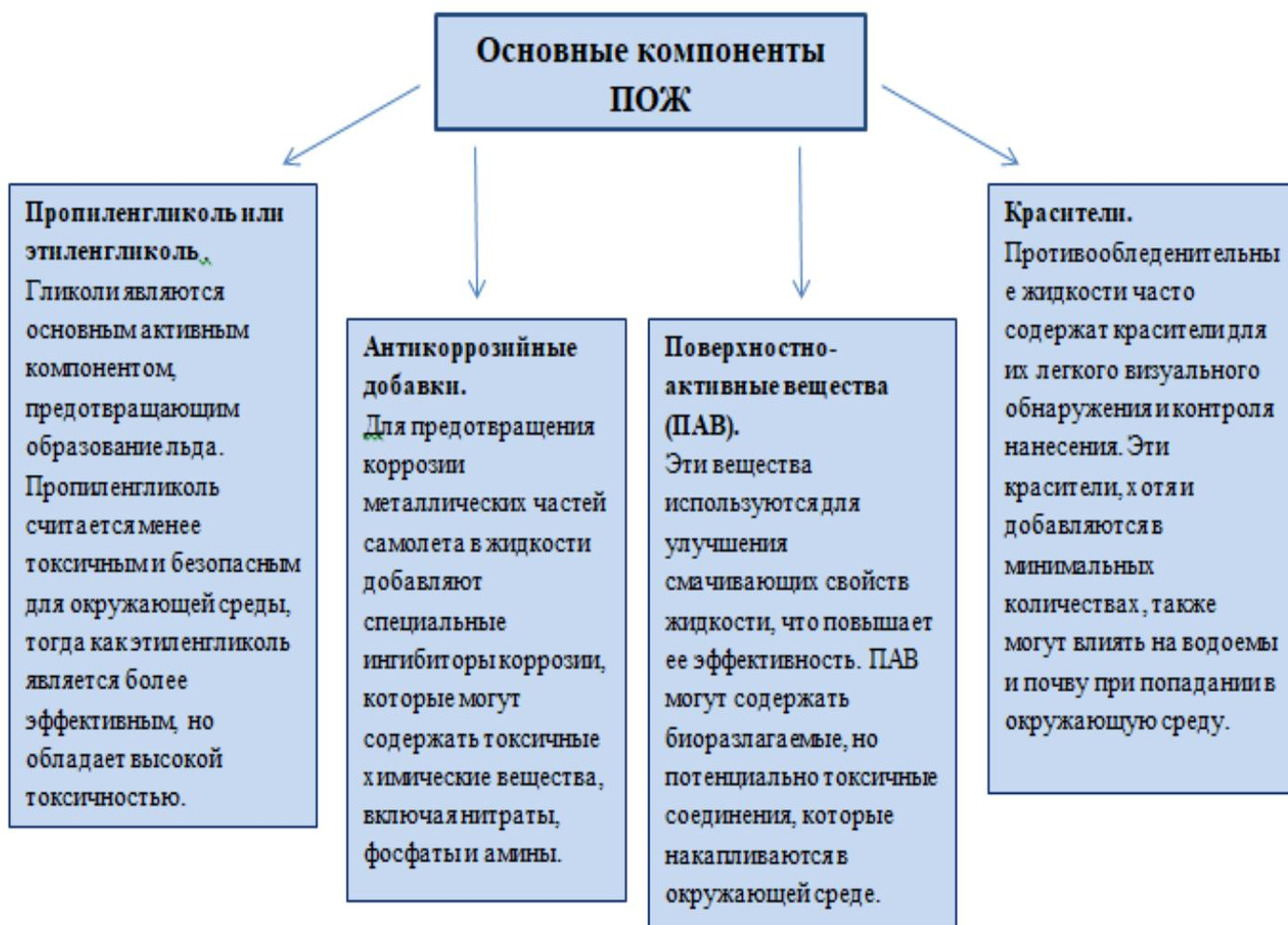
Рис. 1. Схема основных компонентов ПОЖ.
