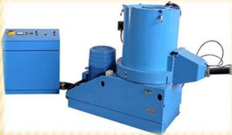
Агломератор — средство, выполняющее полную или частичную обработку вторсырья. Может использоваться в качестве аппарата для: отмывки, очистки, агломерирования, измельчения и сушки сырья.
